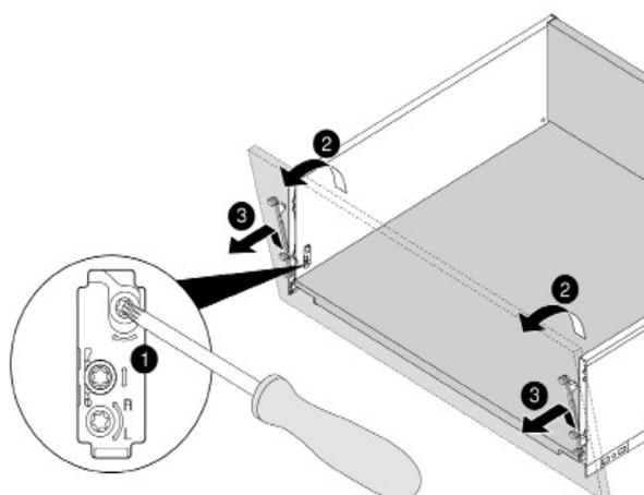
1. För att demontera lådfront, vrid skruv åt höger.
