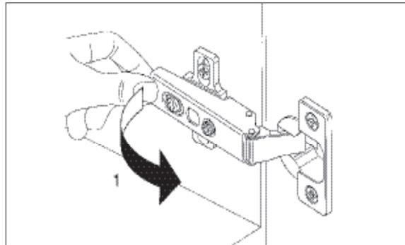
För att demontera köksluckan, tryck med pekfingeret in det metallclips som sitter i bakkant på gångjärnet.
