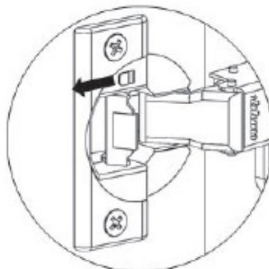
Avaktivera dämpning genom att skjuta det gråa plastreglaget bakåt.
